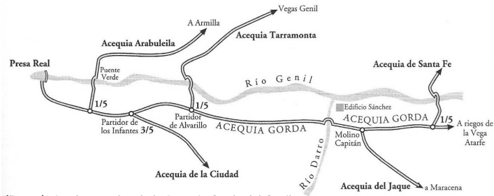
(fig. 15) Azud y ramales de la Acequia Gorda del Genil. Dibujo extraído de El agua en Granada y su entorno .
